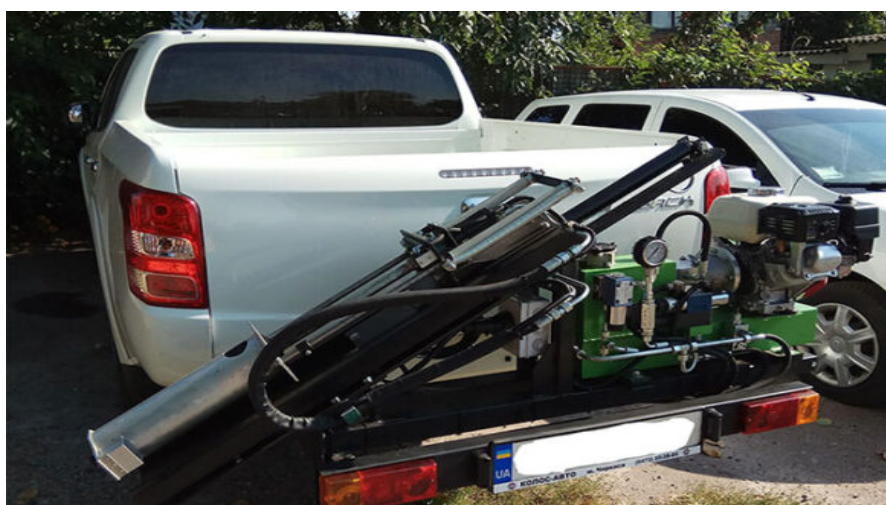
Рис. 1. Автоматизований пробовідбірник для відбирання зразків ґрунту
