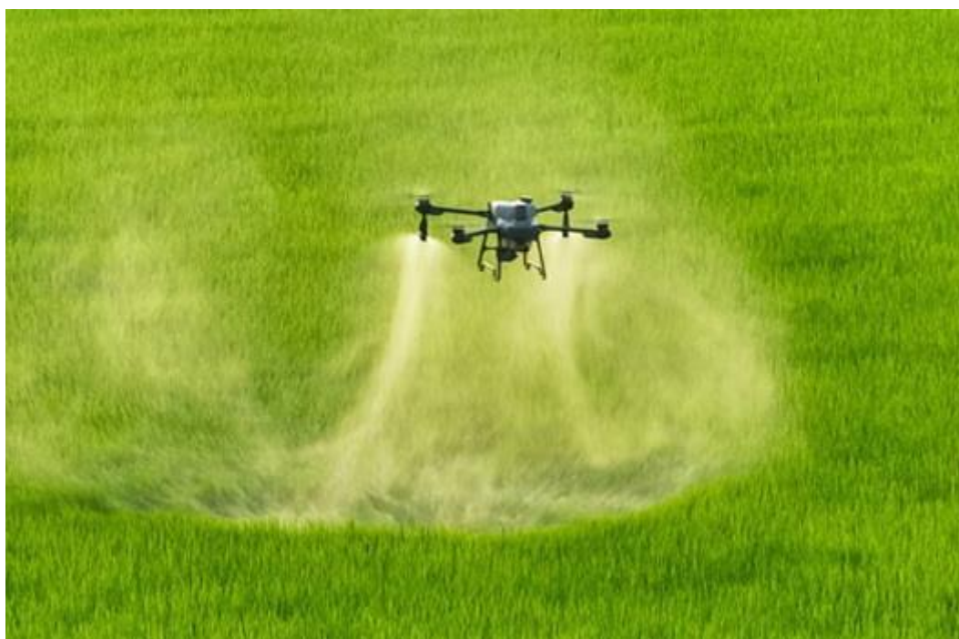
Рис. 2. Візуалізація потоків повітря створюваних гвинтами дрона DJI Agras T20
